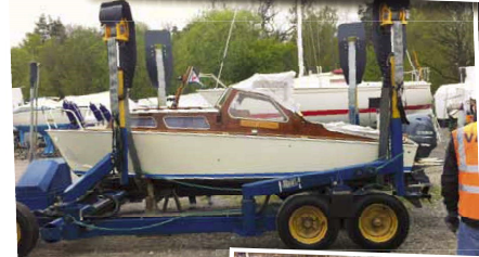
Sjösättning med SUB-lift
